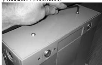
7. Za pomocą 2 śrub ustalających przykręcić z powrotem górną pokrywę.
