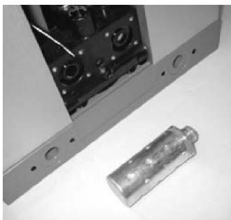
5. Tłumik można dokładnie oczyścić ciepłą wodą z mydłem. Do czyszczenia nie używać ostrych narzędzi.
