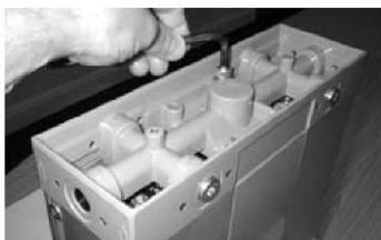
4. Wyjąć głowicę wielokanałową – odkręcić 4 śruby ustalające.
