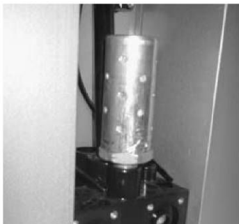
1. Tłumik najlepiej zdemontować przy okazji wymiany przepon - patrz §11.8.
