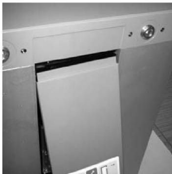
5. Zamontować ponownie płytę – dopasować wystającą część do szczeliny, docisnąć na górze
