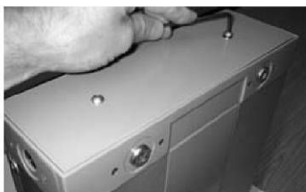
2. Zdjąć górną pokrywę - odkręcić 2 śruby ustalające.
