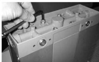
6. Obrócić głowicę wielokanałową o 180° i wymienić – odkręcić 4 śruby ustalające. Sprawdzić, czy 2 'O'Ringi w zaworach są prawidłowo zamocowane.
